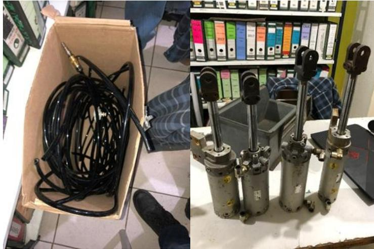
Figura 19: mangueras, espiga y los cilindros
