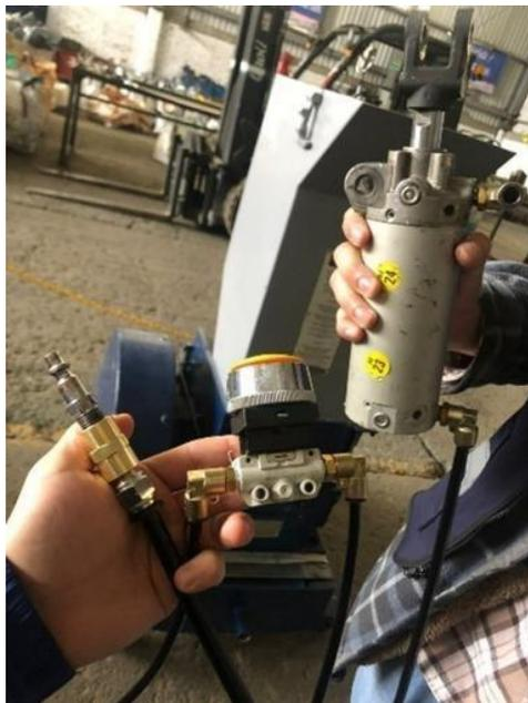
**Figura 22: pistón para prueba conectado a una espiga y un botón**
